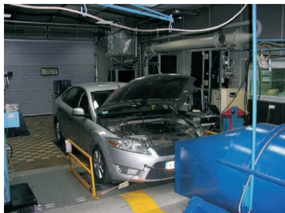
Rys. 7. Ogólny widok samochodu podczas badań stanowiskowych w zakresie pomiaru emisji toksycznych składników spalin w teście europejskim NEDC (UDC + EUDC)
