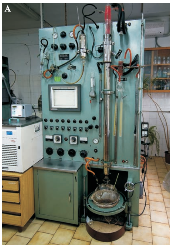
Rys. 2. Aparatura destylacyjna: A – aparat zgodny z ASTM D 2892, B – zgodny z ASTM D 5236
