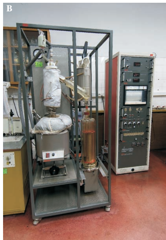
Rys. 2. Aparatura destylacyjna: A – aparat zgodny z ASTM D 2892, B – zgodny z ASTM D 5236
